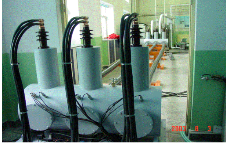
图3 三相高温超导电缆整体装置
