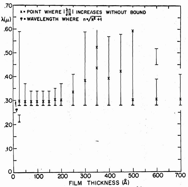
FIG. 3-14a WAVELENGTH REGION WHERE 13 1 ≥ 20 FOR THE R-T MODEL OF A Ge FILM ON CaF2.
