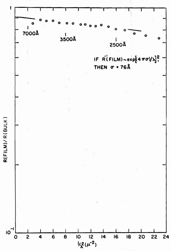
FIG 4-14 ROUGHNESS PLOT FOR THE 1850 & EPITAXIAL Ge FILM ON Co F2.
