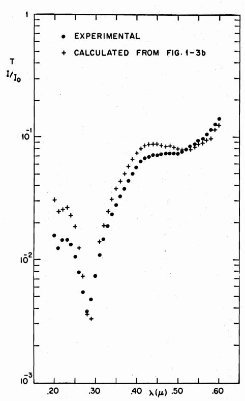
FIG. 4-126 TRANSMISSION OF A 250Å EPITAXIAL GERMANIUM FILM ON Cof2.
